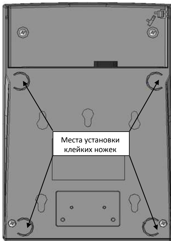
Рисунок 26. Места установка клейких ножек 3M Scotchmate нижней части корпуса изделия
