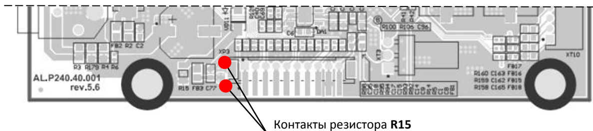
Рисунок 28. Контрольные точки блока управления изделия (верхняя сторона, показана не полностью).
