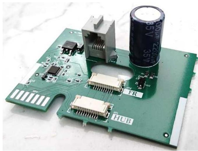
Рисунок 6. Плата денежного ящика AL.M020.45.00 (вид сверху)
