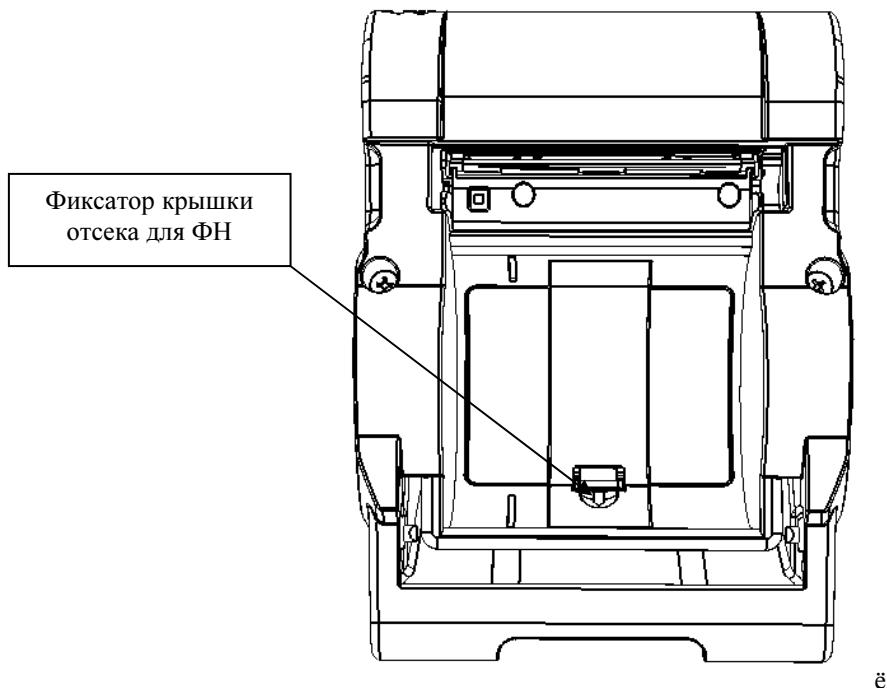
Рисунок 10. Расположение фиксатора крышки отсека для ФН
