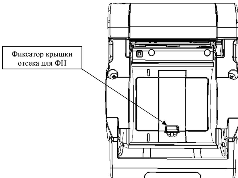
Рисунок 10. Расположение фиксатора крышки отсека для ФН
