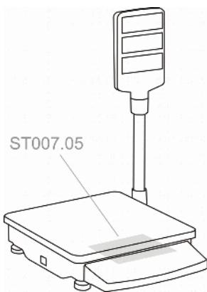
Плата ST007.05 — это плата БОИ (блока обработки информации) весов Штрих М3 со светодиодной индикацией. Настройка платы заключается в калибровке встроенного в нее вольтметра.
