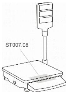
Плата ST007.08 — это плата БОИ (блока обработки информации) весов Штрих М3 со светодиодной индикацией. Настройка платы заключается в калибровке встроенного в нее вольтметра и ШИМ регулятора напряжения питания индикации (5 Вольт).
