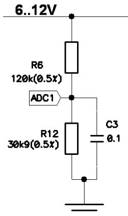
В плате ST007.08 есть встроенный вольтметр, который измеряет напряжение питания весов. Он состоит (см. схему) из делителя на резисторах R6, R12 и встроенного в микроконтроллер DD4 АЦП. Напряжение измеряется на контакте 1 разъёма X1 (на этот контакт, через выключатель, приходят объединенные с помощью диодов напряжения от аккумулятора, батареек и сетевого источника питания).
