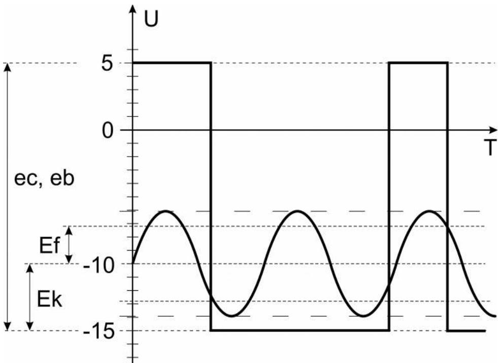
Рисунок 1: Напряжения питания вакуумно-люминесцентных индикаторов Futaba 7-LT-131GNK в весах Штрих M5T версии 3 и Штрих M3.
