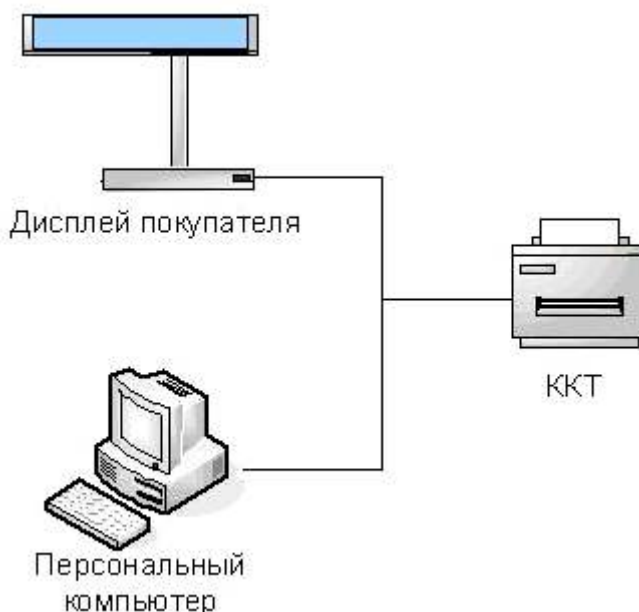
Рисунок 2. Подключение управляющих устройств к ККТ
