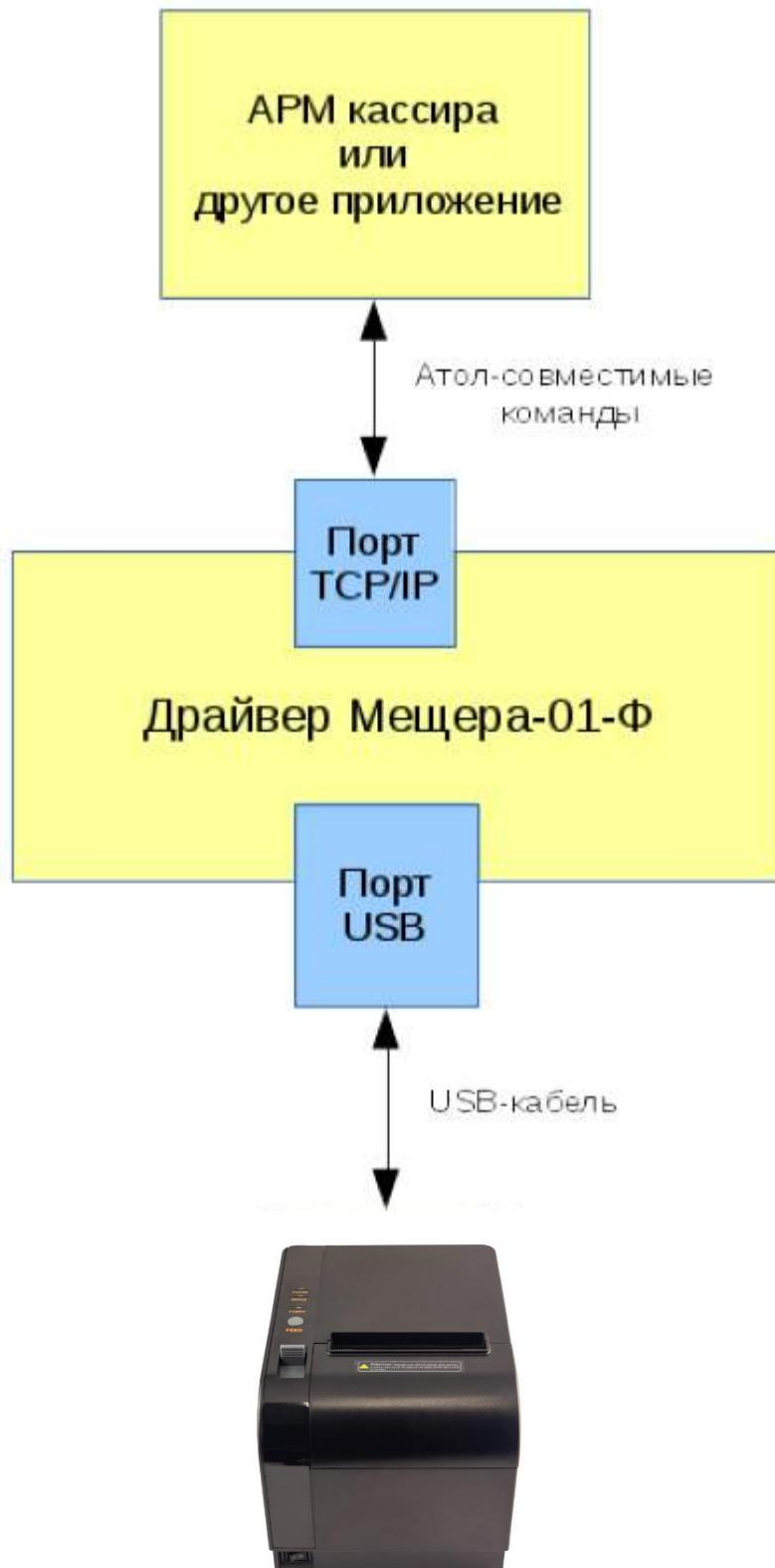
Драйвер позволяет использовать одновременно несколько ККТ. Для каждой ККТ требуется использовать уникальный номер TCP/IP порта. Непосредственно после запуска драйвера, если подключена хотя бы одна
