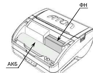
Рисунок 4. Расположение АКБ и ФН в корпусе ККТ
