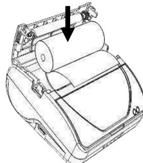
Рисунок 2. Установка ЧЛ в лоток
