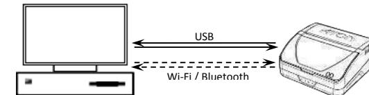
Рисунок 5. Подключение ККТ к ПК
