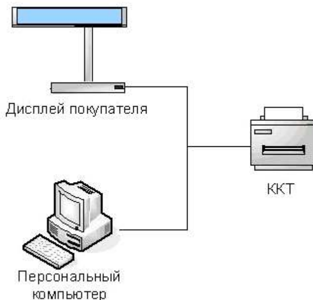
Рисунок 3. Подключение управляющих устройств к ККТ
