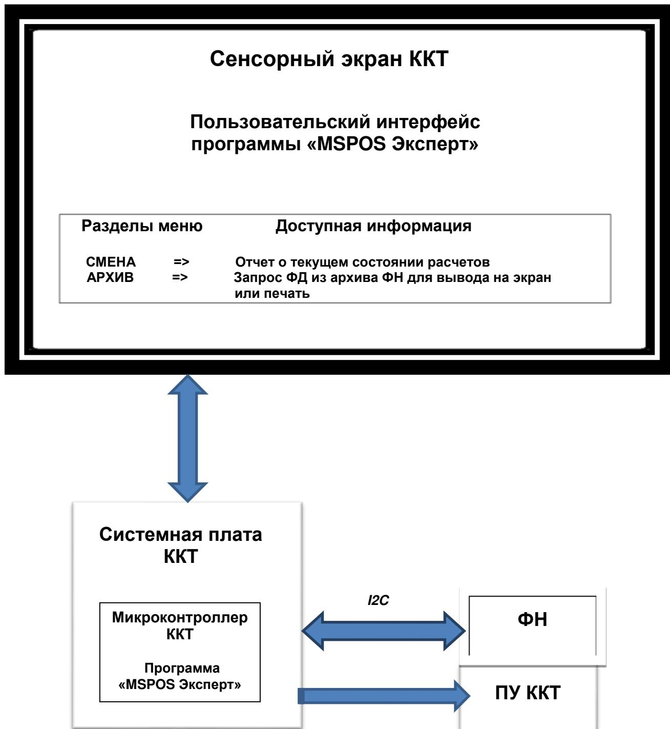
**Приложение 3****Проверка функционирования ККТ«MSPOS-E-Ф»**
