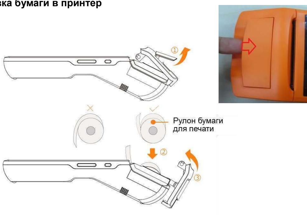
1. Крышка отсека принтера открывается с помощью ручки. Открытие крышки с применением усилия может повредить шестерни принтерной головки.
