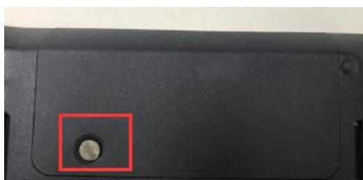
Снять крышку и вынуть батарею.
