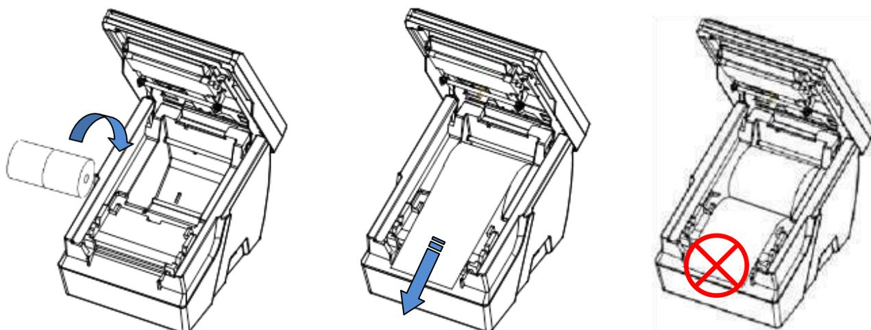
**Шаг 1:** Откройте крышку принтера с помощью рычага крышки принтера. Поместите рулон бумаги в ложемент принтера так, как показано на рисунке выше. Избегайте неверного положения рулона.
