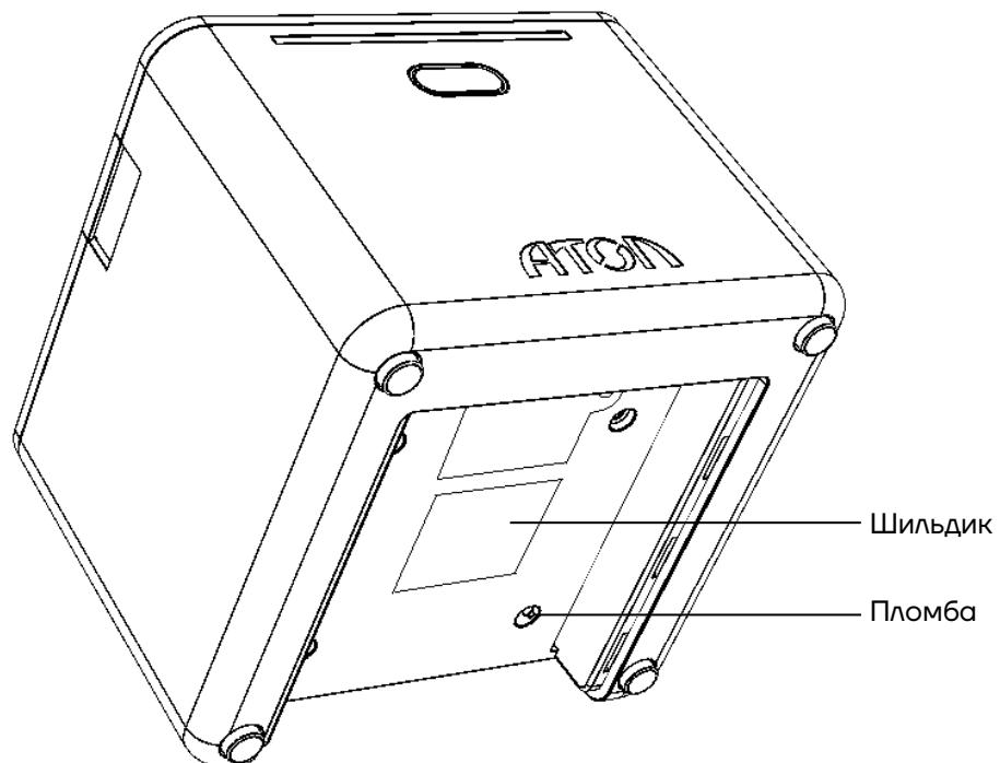
Рисунок 1. Расположение шильдика и пломбы на корпусе ККТ
