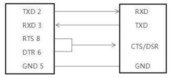
Последовательный интерфейс принтера, разъем DB9 интерфейс ПК кассовой системы (POS), разъем DB9
