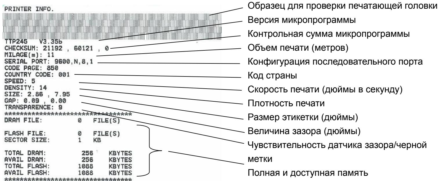
Рис. 29. Распечатка самопроверки
