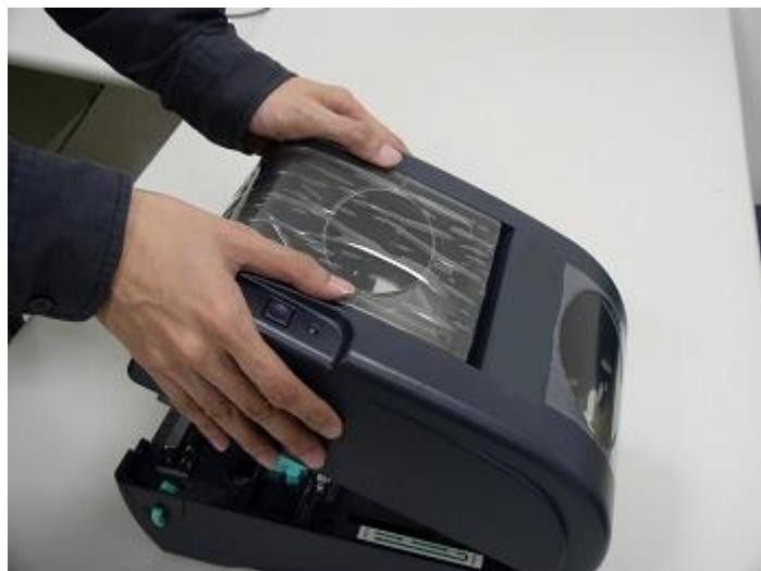
Рис. 3. Закрывайте верхнюю крышку двумя руками
