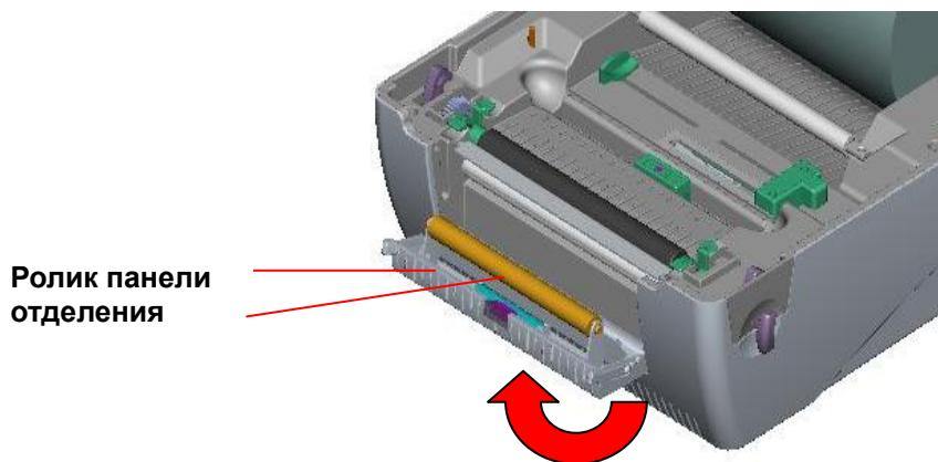
**Рис. 17. Установка панели отделения (II)**
