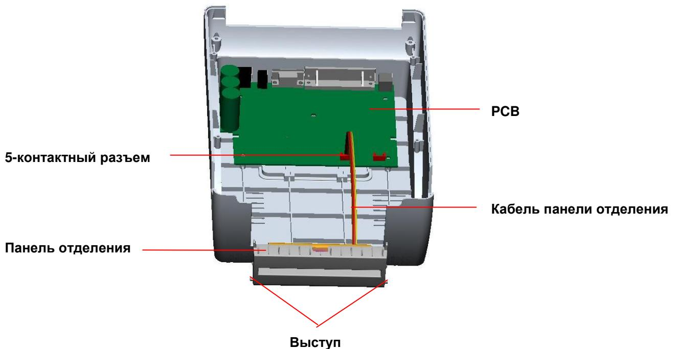
**Рис. 14. Подключите кабель датчика отделения к основной плате**
