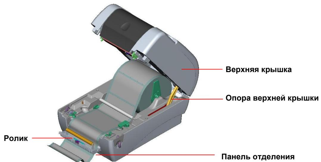
**Рис. 20. Пропустите бумагу через отверстие бумажной подложки под роликом и отделите часть этикетки**
