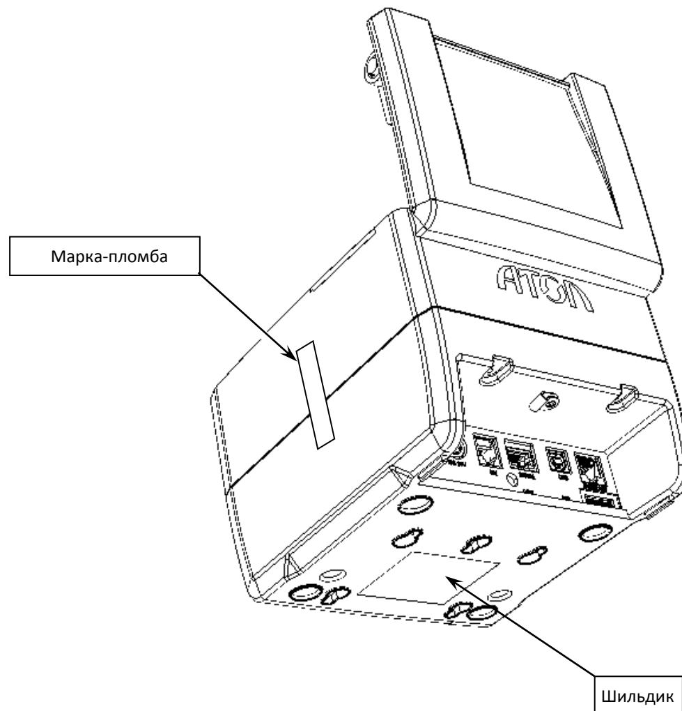
Один элемент марки-пломбы наклеивается на кожух, закрывающий блок управления и устройства печати кассовых чеков так, чтобы было невозможно получить доступ к внутренней части ККТ без разрушения марки-пломбы. Шильдик наклеивается на дно корпуса ККТ.
