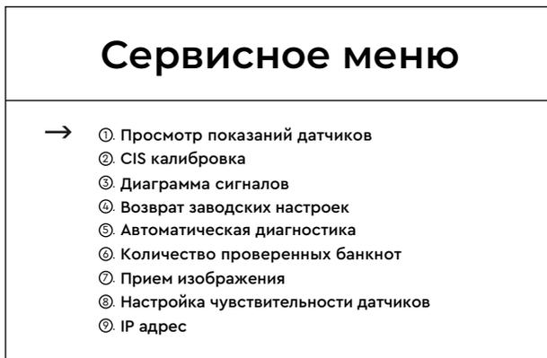
Пункт «1.Просмотр показаний датчиков» предназначен только для служебных целей; используется, чтобы обнаружить неисправность какого-либо датчика.
