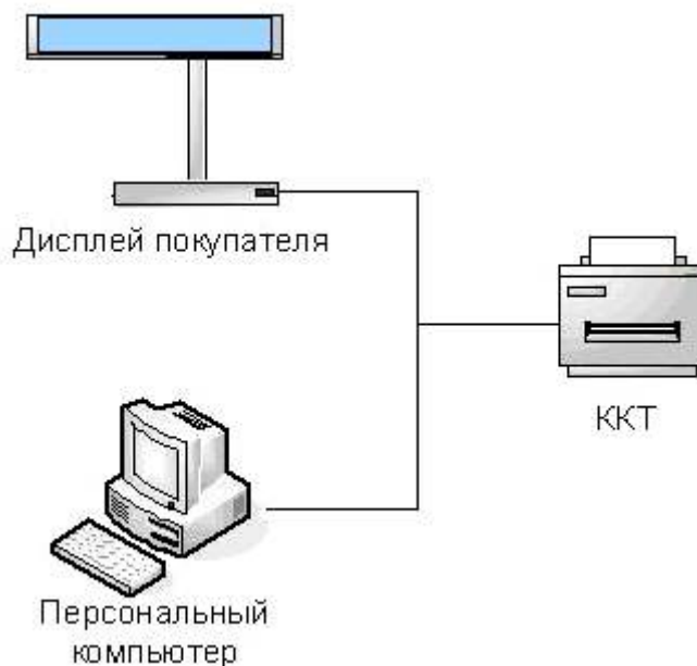
Рисунок 3. Подключение управляющих устройств к ККТ
