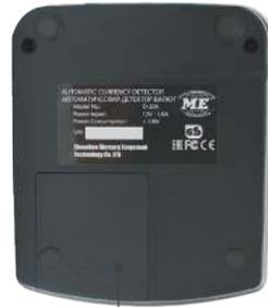
Крышка аккумуляторного отсека
